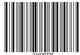
Codabar (encoding A34698735B)
